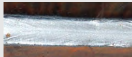
S355, t = 10 mm, T-Stoß, Kehlnaht ohne Schweißnahtvorbereitung, Schweißstrom = 316 A, Schweißspannung = 28,8 V, DV = 10,5 m/min, vs = 50 cm/min
