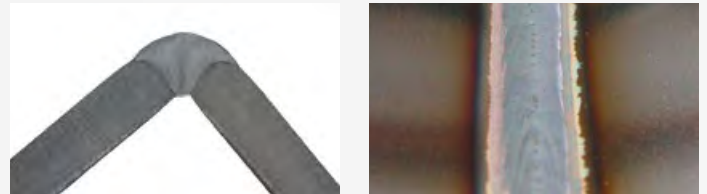
Minimierte Wärmeeinbringung: nahezu spritzerfrei. CrNi-Ecknaht 1 mm Blech, mit coldArc.
