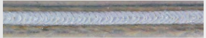
Kehlnaht, 1 mm Blech, AlMg, Argon, 1,2 mm Drahtelektrode
