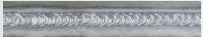
Kehlnaht, 8 mm Blech, AlMg, Argon, 1,2 mm Drahtelektrode, perfekte Schuppung durch superPuls
